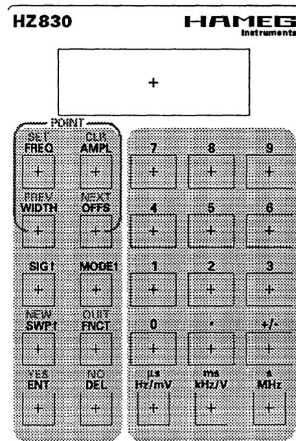
**Achtung! Die Tastatur darf nur bei ausgeschaltetem Gerät angesteckt/entfernt werden. Dateneingabe**
